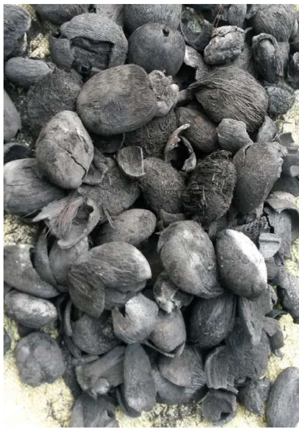
ภาพที่ 4-17 แสดงถ่านผลตาลโตนดที่ได้จากการเผาก่อนการร่อนนำเอาเส้นใยเปลือกออก ซึ่งจะกอบด้วยถ่านที่เต็มผล และถ่านที่แตก
