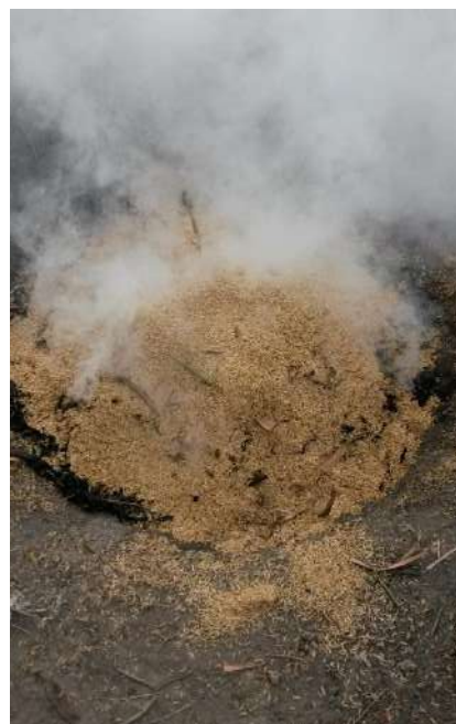
ภาพที่ 4-16 แสดงการใช้วัสดุต่างๆที่เหลือใช้ในท้องถิ่นเป็นเชื้อเพลิงในการเผาถ่านผลตาลโตนด
