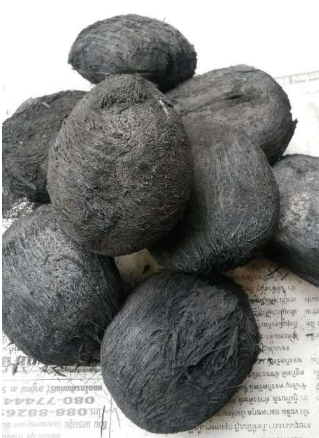
ภาพที่ 4-17 แสดงถ่านผลตาลโตนดที่ได้จากการเผาก่อนการร่อนนำเอาเส้นใยเปลือกออก ซึ่งจะกอบด้วยถ่านที่เต็มผล และถ่านที่แตก
