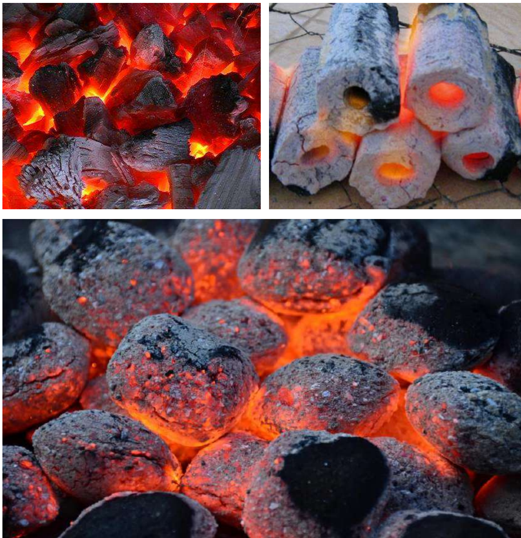
ภาพที่ 1-1 แสดงลักษณะการติดไฟของถ่านไม้ ถ่านอัดแท่ง และถ่านผลตาลโตนด
