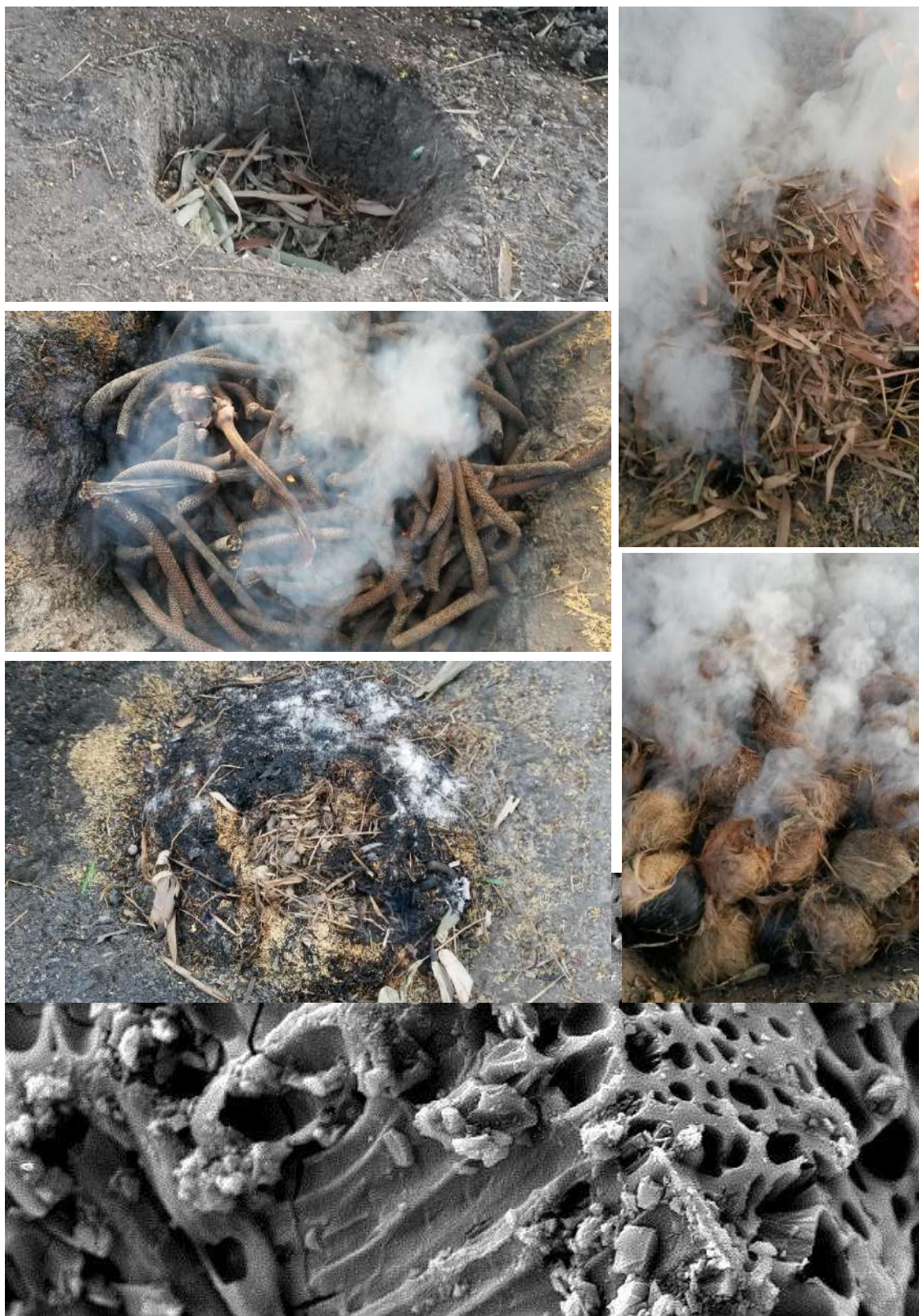
ภาพที่ 4-11 แสดงการเผาถ่านผลตาลโดนดในหลุมกลม และความพรุนของโครงสร้างถ่านผลตาลโดนด
