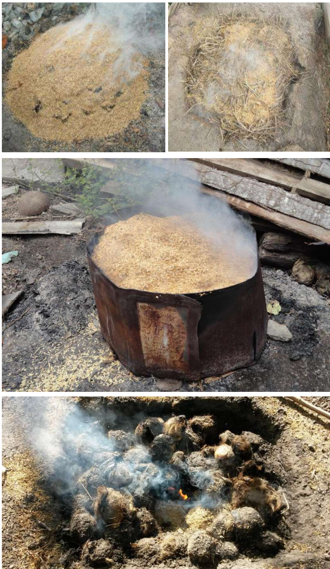
ภาพที่ 4-6 แสดงการใช้แกลบและฟางข้าวเป็นเชื้อเพลิงและปิดกลบปากหลุมเผาถ่านผลตาลโตนด
